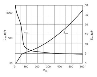
Fig. 6 -  $C_{\text{oss}}$  and  $E_{\text{oss}}$  vs.  $V_{\text{DS}}$
